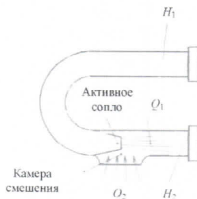
Рисунок 2.1 Схема работы гидроэлеватора Г-600А
